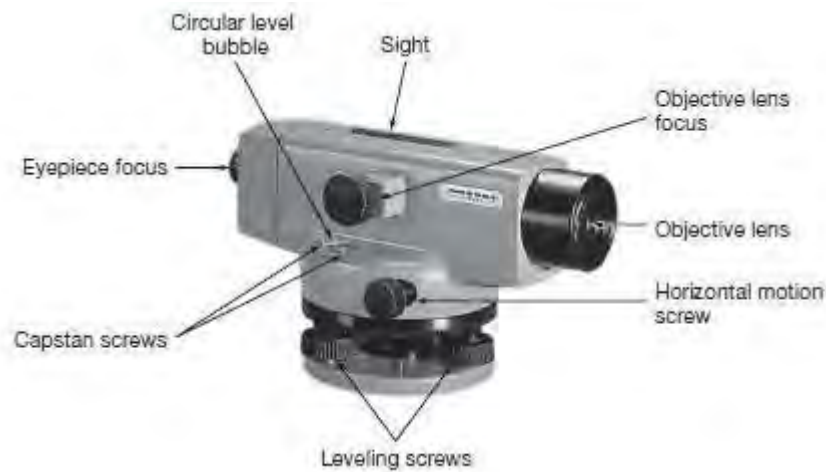
Gambar 1.3. Bagian-bagian umum dari pesawat sipat datar
