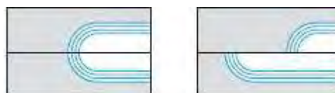
Gambar 1.7. Gambar kiri, Posisi yang benar pada nivo tabung, dan gambar kanan posisi yang salah karena deviasi dari gelembung.
