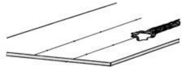
Kecepatan las terlalu lamban Alur las cacat
