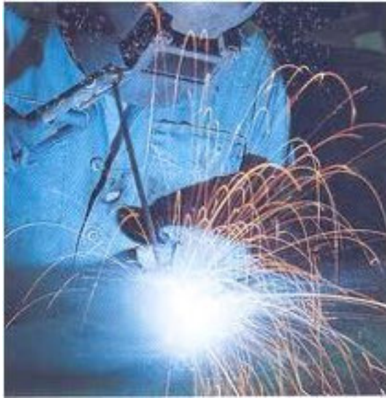
Gambar Penyalaan busur listrik pada las SMAW
